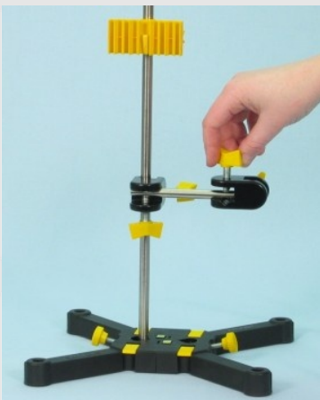
Fijando la barra de soporte corta en la doble nuez
